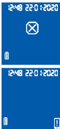
automatisch. Na enkele seconden verschijnt het pictogram "Correcte verwerking" 4 seconden lang op het scherm van de Meter. Het pictogram "Apparaat niet langer gepaird" verschijnt in de rechteronderhoek van het scherm.
