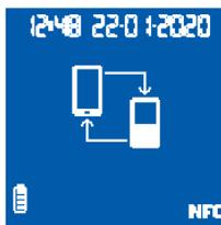
Proces párování lze kdykoli zrušit stisknutím levého tlačítka nebo vložením Chip.
