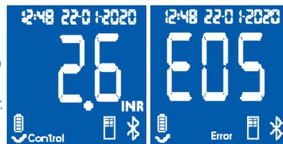
Los mensajes de error se representan mediante una letra “E” seguida de un número. Si obtiene un código de error siga los pasos descritos en el apartado “Guía de errores”.
