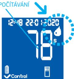
Pokud vložíte vzorek a neozve se žádný zvuk, znamená to, že objem vzorku nebyl dostačující. Chip vyjměte a test zopakujte s novým Chip. Při zasouvání zkontrolujte, zda je velikost kapky dostačující a zda nedošlo k zablokování vstupního kanálu.
