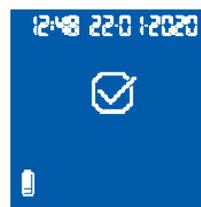
Una volta avviato il processo di associazione, il Monitor microINR Link consentirà per 60 secondi di eseguire l'associazione con un dispositivo compatibile. Se il Monitor microINR Link non riesce a collegarsi a un altro dispositivo, verrà visualizzato il simbolo "Processo errato".
