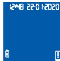
Para salir el menú de Bluetooth, pulse el botón derecho hasta llegar a la opción de "Salida" (consulte la sección 5.2). También puede salir insertando un Chip microINR o tras 20 segundos de inactividad, el Monitor microINR Link saldrá automáticamente del menú.
