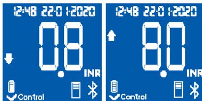
*Si obtiene un resultado fuera del rango de medición, la pantalla mostrará ↓ 0.8 (inferior a 0.8) o ↑ 8.0 (superior a 8.0).*
