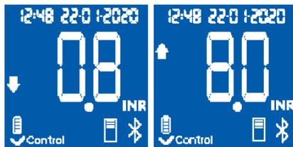
*Si vous obtenez un résultat hors de la plage de mesure, l'afficheur indique ↓ 0,8 (inférieur à 0,8) ou ↑ 8,0 (supérieur à 8,0).*
