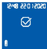
Depois de iniciar o processo de emparelhamento, o Medidor microINR Link fica acessível durante 60 segundos para emparelhar com um dispositivo compatível. Se o Medidor microINR Link não se ligar a outro dispositivo, será apresentado o símbolo de "Processo Incorreto". Será apresentado o símbolo de "Dispositivo Desemparelhado" no canto inferior direito do visor.
